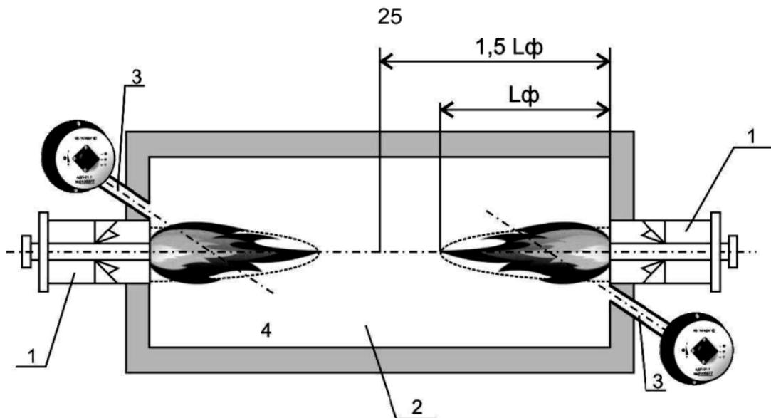
Рис. 13. Расположение визирных труб в двухгорелочной топке с оппозиционным расположением горелок.
