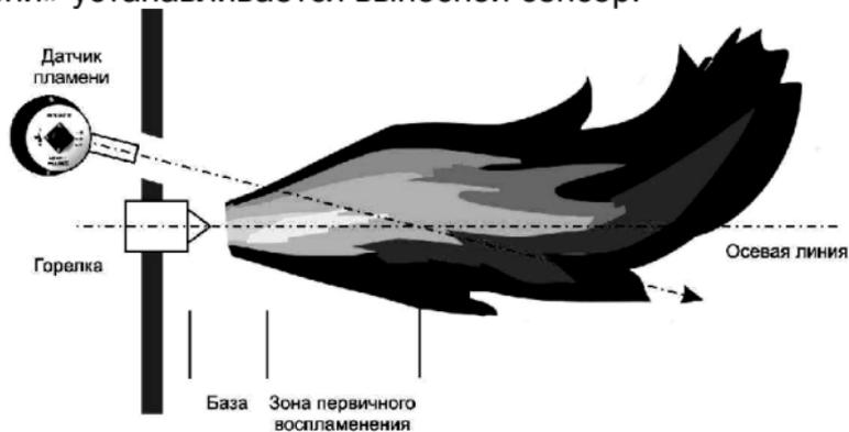
Расположение датчика относительно контролируемого пламени.
