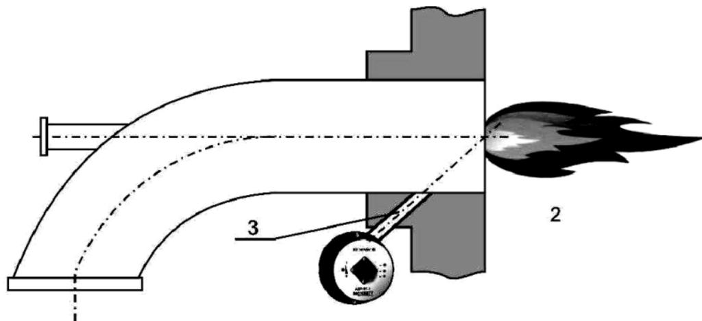
Рис. 12. Схема установки визирной трубы на втором ярусе трёхгорелочного двухъярусного котла (например, котел КВГМ.)
