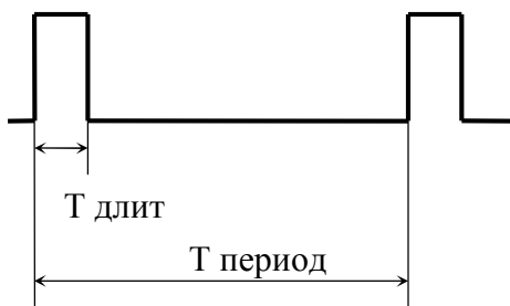
Рисунок 2 – Последовательность импульсов ШИМ
