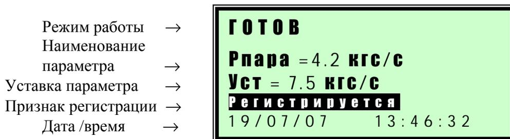
Рисунок 1 - Содержание экрана дисплея контроллера с опцией регистратора
