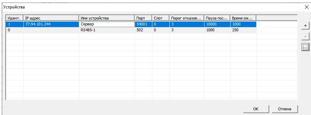
Устройство «Сервер» на рисунке выше описывает сервер, принимающий данные от прибора. Просмотреть или изменить его параметры можно с помощью кнопки «...», расположенной в правой части окна.
