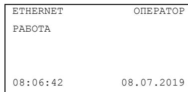
В верхней строке основного окна отображаются текущий установленный канал связи («Ethernet» или «GPRS») и имя активного пользователя («Оператор» или «Наладчик»). Пользователю «Оператор» доступен только просмотр параметров на основном экране и в меню, пользователю «Наладчик» доступно изменение режима работы контроллера и параметров в меню.
