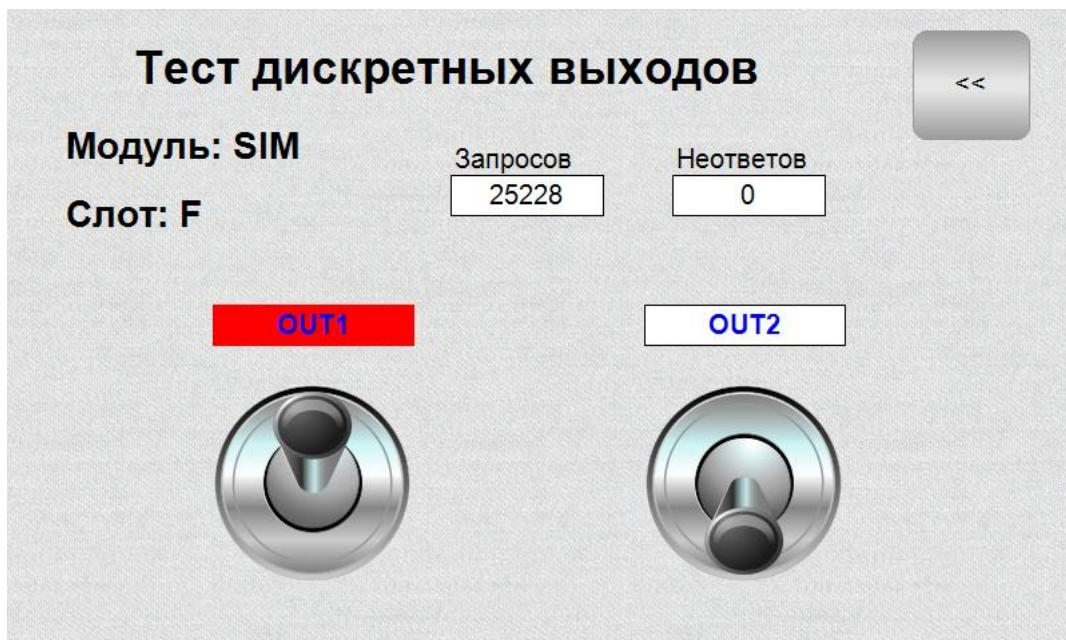
Рисунок 3-6. Экран тестирования модуля дискретных выходов типа «симистор»
