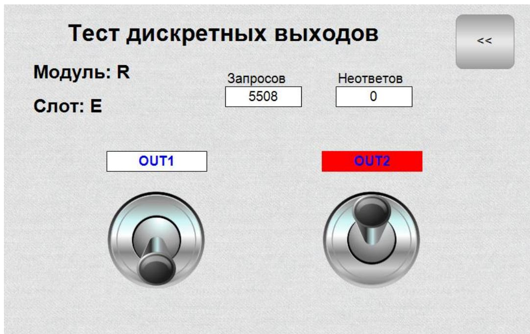
Рисунок 3-8. Экран тестирования модуля дискретных выходов типа «реле»
