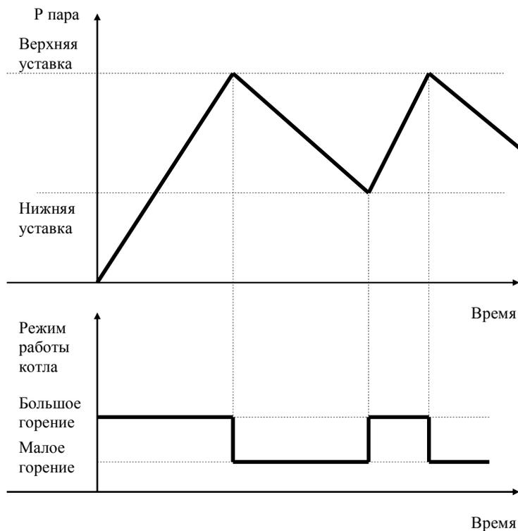
Рисунок Г.1 – График позиционного регулирования мощности котла
