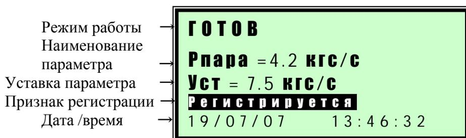
Рисунок 1 - Содержание экрана дисплея контроллера с опцией регистратора
