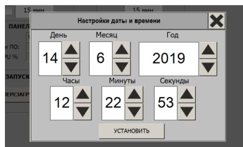
Рисунок 5.14 – Настройка даты и времени прибора
